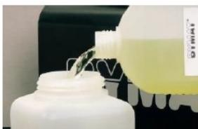
Versez maintenant un peu d'électrolyte dans le récipient à col large en veillant à ne rien renverser.
