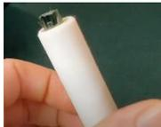
Durch Drehen der Verstellhülse lässt sich die Bündelung des Pinsels einstellen, dadurch lässt sich der Pinsel schonender und genauer betreiben. Je weiter der Pinsel herauschaut, um so weiter spreizen sich die Borsten. Dies kann ein ineffektives Reinigen bewirken.
